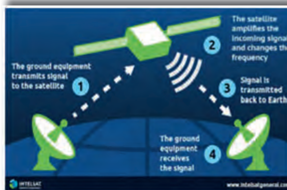
Figura 2: Principiul de funcționare (Intelsat)
